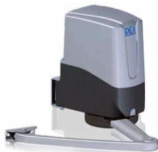
**Moteur pour portail battant** n'excédant pas 4 m entre piliers (écoinçon mini 400 mm, voir notice technique). Son armoire de commande est intégrée au moteur avec encodeur (fin de course mécanique disponible). Câble avec 7 fils de 6 m de long fourni avec le moteur.
